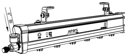
▶ 将棒体上的气源接头连接至气源发生设备，打开气源开关，注意压缩气流最高使用压力，以免离子棒出现故障。
