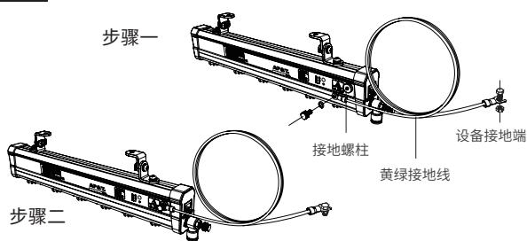
▶ 将黄绿接地线的一端电连接到离子棒的接地螺柱上，另一端电连接到交流设备地。
